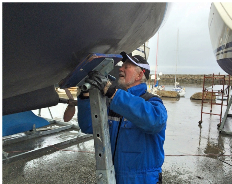
Ook waar de steunen zitten moet geveerd worden!
