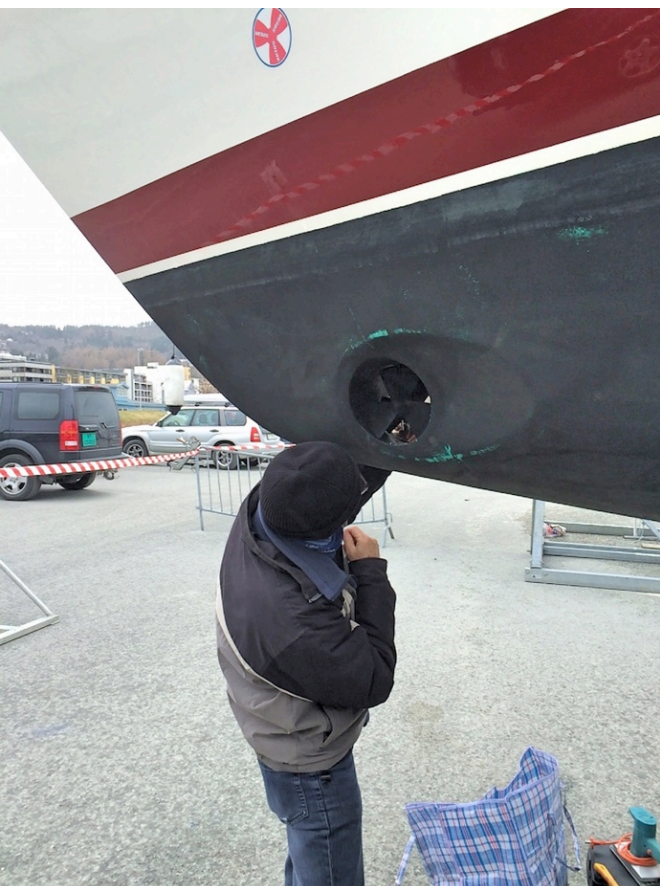
Onderhoud van de boegschroef
