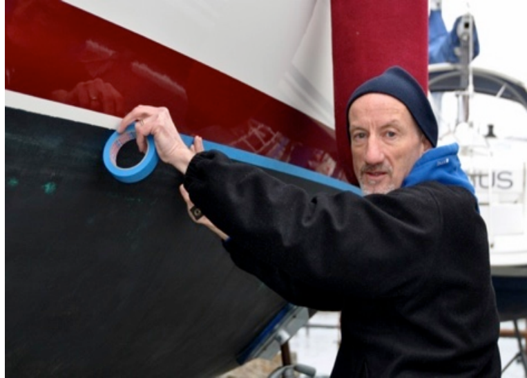
Vorbereiding voor het verven van de onderkant
